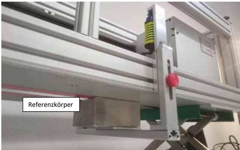
Abb. 3: Befestigungsklammer für Referenzkörper
